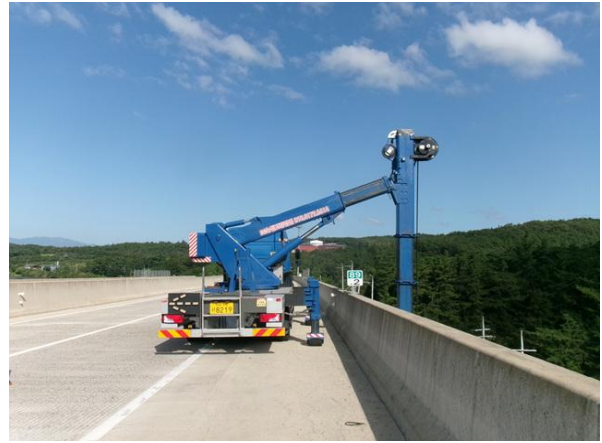
굴절점검차를 이용한 근접조사
